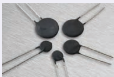
(ب) تصویری از چند ترمیستور دیسکی واقعی
