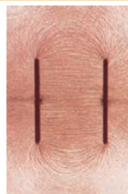
شکل ۱۹-۱ سمت‌گیری دانه‌ها در فضای بین دو الکتروود صفحه‌ای موازی
