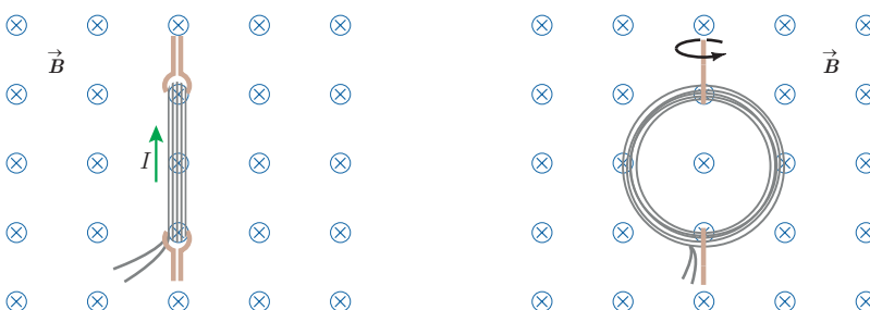
شکل ۳-۲۶ با چرخاندن پیچه درون میدان مغناطیسی \vec{B} ، زاویه بین میدان مغناطیسی و سطح پیچه تغییر می‌کند. این تغییر زاویه سبب القای جریان در پیچه می‌شود.
